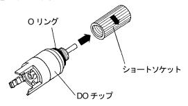
③DO 電極ボディにDOチップを取り付けます。 DO 電極のコネクタ部分にサンプル水が入らないようにしっかりとねじ込んでください。
